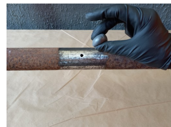
Aplicação da massa epóxi
